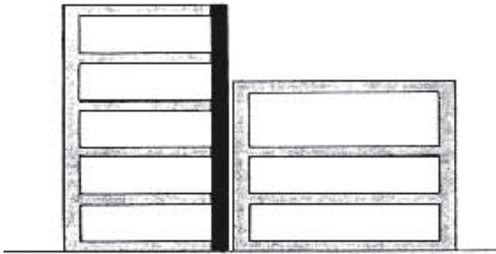
BILD 3: BRANDWAND ZWISCHEN GEBÄUDEN
