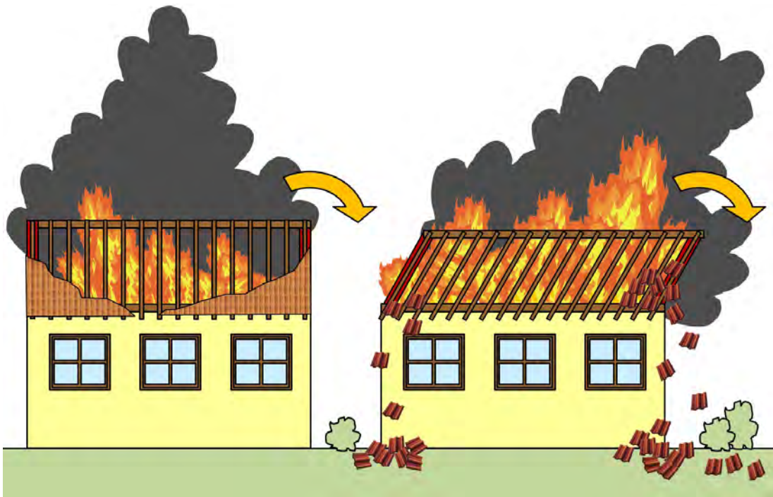
Abbildung 14: Eine zur Seite hin einstürzende Giebelwand kann über die Firstpfette auch die Sparren und die zweite Giebelwand mitreißen.
