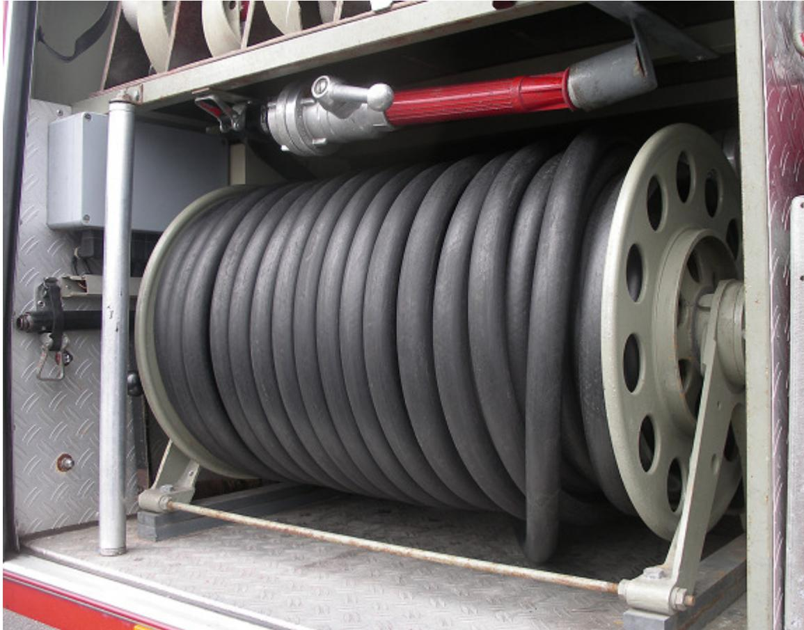
Als Schnellangriffseinrichtung Wasser ist auf der rechten Fahrzeugseite eine Schnellangriffshaspel mit einem formstabilen 30 m langen Druckschlauch untergebracht.
