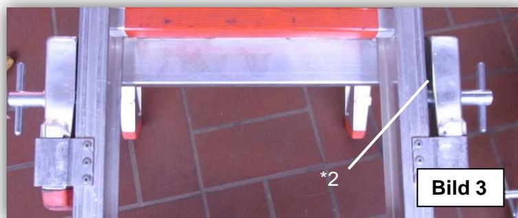
Sollen dennoch Steckleiter- und -verbindungsteile unterschiedlicher Hersteller genutzt werden, ist vor der ersten Inbetriebnahme zu prüfen, ob bei allen sich bietenden Kombinationsmöglichkeiten die Schnappschlösser ordnungsgemäß sitzen und die Spaltmaße so sind, dass die Schnappschlösser wirken.
